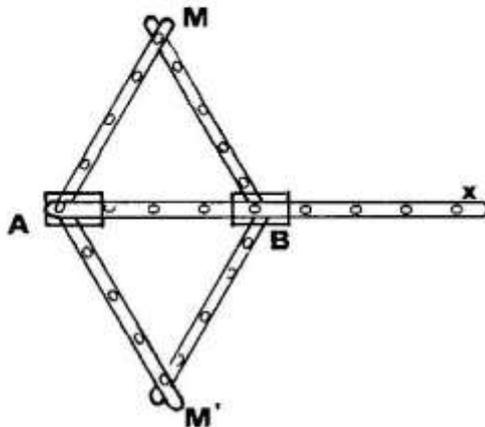
Construindo o losango  $ABMM'$  com dois cursores nos vértices  $A$  e  $B$  e fazendo deslizar os vértices mencionados sobre o eixo  $\overleftrightarrow{OX}$ , suporte da diagonal  $\overline{AB}$ , a cada posição de  $M$  teremos o seu transformado  $M'$  pela simetria em relação a  $\overleftrightarrow{OX}$ .
