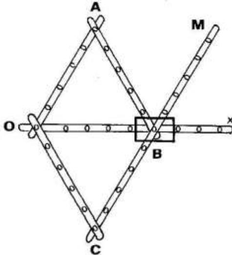
Constrói-se um losango articulado AOCB sendo que o lado CB será formado de uma barra mais comprida, de modo a possuir o prolongamento BM.
