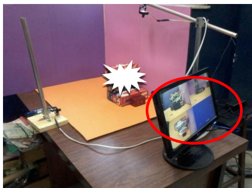
Figura 11 – Apoios menores com tubos metálicos e base de madeira. Planos de papelão revestido com EVA: plano horizontal (laranja); plano vertical (roxo) e plano de perfil (rosa)
